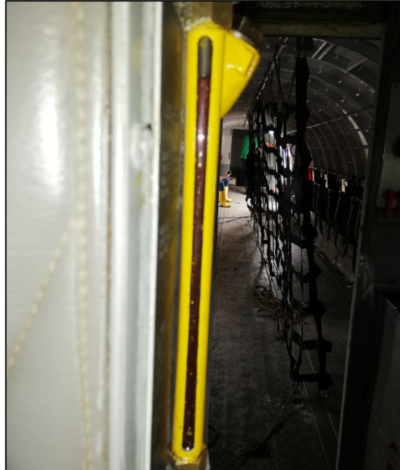
Fotografía No. 6: Medidor y cantidad de aceite hidráulico HK2820
