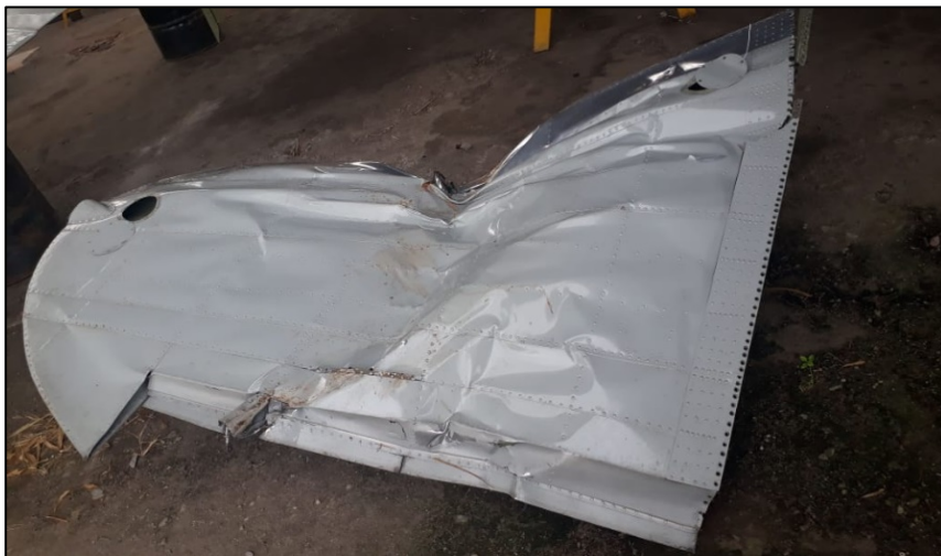
Fotografía No. 2: Condición punta del plano derecho aeronave HK2820
