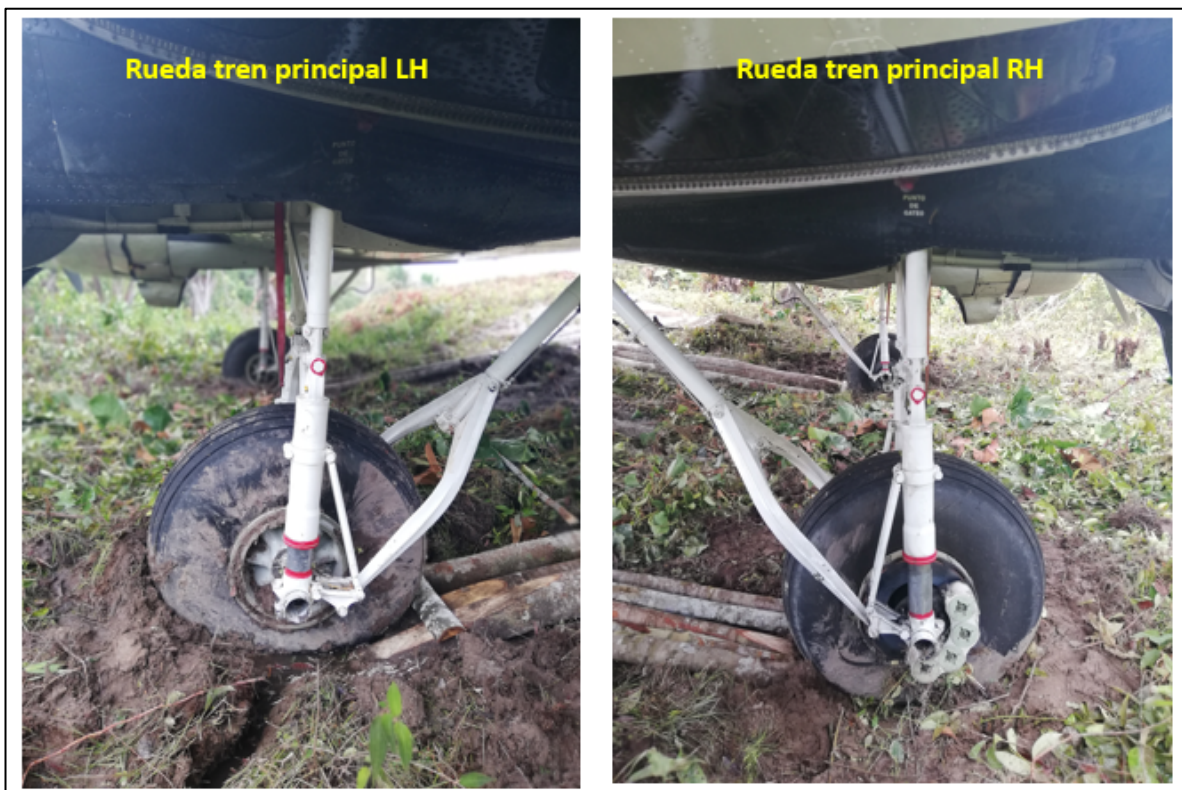
Fotografía No. 5: Estado tren principal de aterrizaje HK2820
